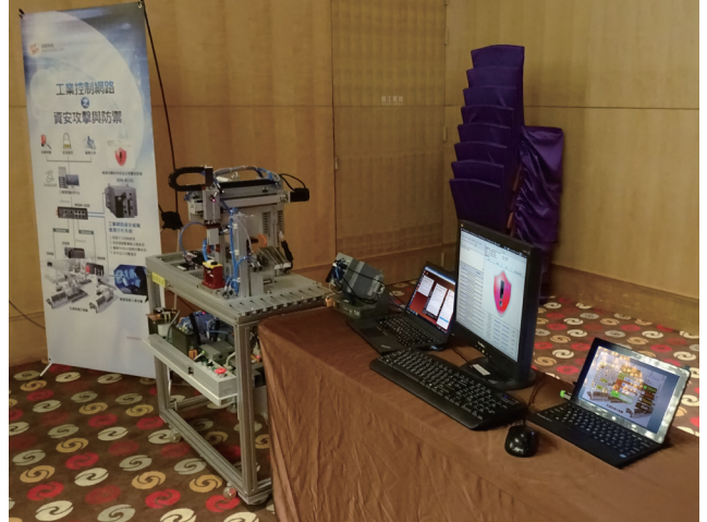
▲ 泓格科技推出 iDS-8131 工业网络资安威胁侦测分析系统，可侦测攻击的封包并出现告警讯息
