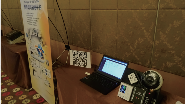
▲ WISE-5231 可将 I/O 的讯息和摄影机拍下的照片，实时推播到手机上的 Line 联络人和聊天室
